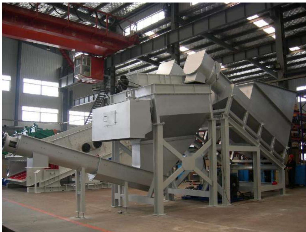
图 4.1-2 卸料槽及分拣机
