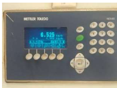
图 3.2-3 活性炭喷射混合器投放活性炭设备计量表
