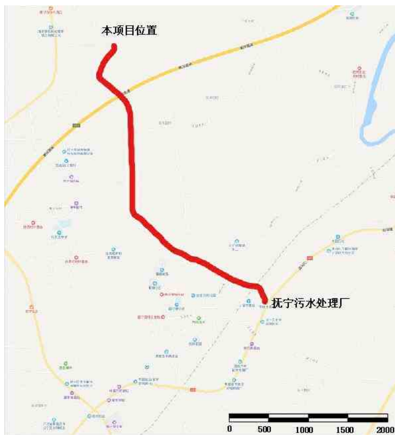
图 3.10-2 本项目至抚宁区污水处理厂给排水管网路线示意图
