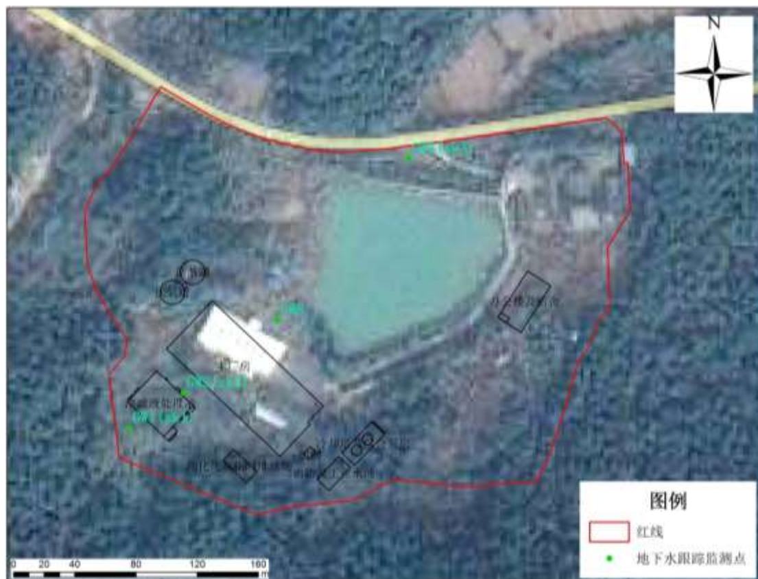
图 6-2-5 地下水跟踪监测井(孔)情况图
