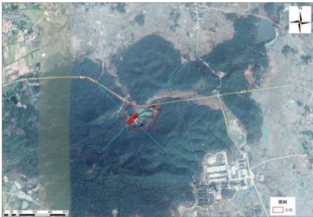
图 5-6-4 事故状况下 \text{NH}_4\text{-N} 在含水层中的污染晕预测图
