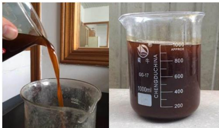
图 3.1-9 离心机提取的工业粗油脂（含水率 \leq 2\% ）
