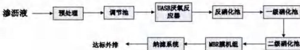
图 4-24 渗滤液处理工艺流程图
